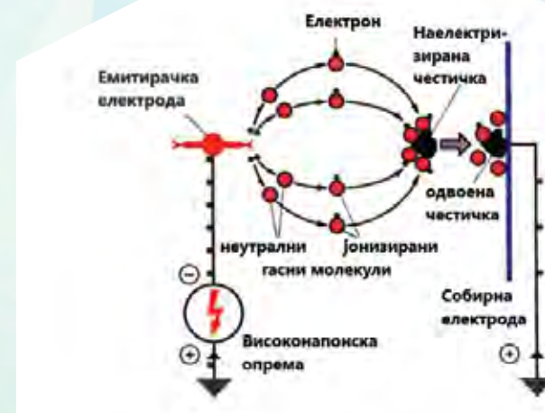
Принцип на работа на Електростатските филтри
